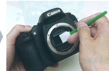
▲カメラをクリーニングモードにし、グリーンスワブで1方向に1回だけローパスフィルターを拭く。これだけで、ムラなく均一にゴミや汚れを拭き取ることができる。なおスワブは使い捨てだ。
