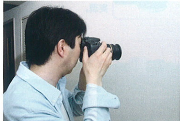
▲ローパスフィルターに付着したゴミの確認をするには、レンズの絞りを最小にし、ISOをベース感度に。そして白い無地の壁や紙を手持ち撮影する。手ブレしているはずなのにしっかり写っている黒い物体があれば、それがゴミだ。
