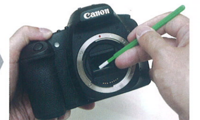
▲取りにくい四隅のゴミや汚れは、グリーンセンサーコーナースワブで拭く。スワブに使用されているパッドは、ホコリが一切でない特殊繊維なので、安心して使用できる。
