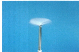
▲清掃する前に、本体に電源を入れてブラシを回転させ、ブラシに付いているゴミを払い落とす。カメラ内部にゴミをまき散らさないようにするため。同時にブラシも帯電させている。
