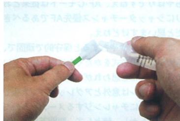
▲グリーンスワブは、まずクリーニング液をパッドに2〜3滴みこませる。写真では油性用のVDustフォーミュラだが、汚れが水性の場合はセンサークリーンリキッドを使用する。
