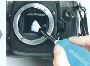
▲カメラをセンサークリーニングモードにし、ミラーアップとシャッターを開放させる。そしてブラシでローパスフィルターをなぞるように動かし、ゴミを吸着させる。
