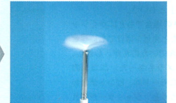
▲清掃が終わったらカメラのクリーニングモードを解除。ブラシは再度回転させ、吸着させていたゴミを払い落とす。これでドライのゴミの清掃作業は終了だ。
